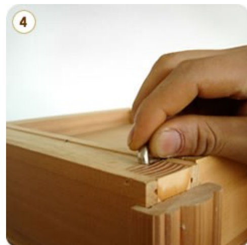
Łączenie dwóch ścianek Użyj zapiecia U ze stali nierdzewnej do połączenia ścianek
